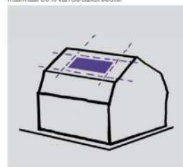
Plaatsing zonnepanelen mansardekap op het bovenste deel van het dak.
